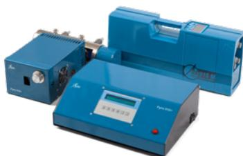
El accesorio **PYRO-915+** incorpora las ventajas únicas de la Espectroscopia de Absorción Atómica de Zeeman, lo que permite el análisis directo de muestras sólidas y líquidas sin la necesidad de realizar procedimientos de preparación de muestras. Con modos de calentamiento programables y control total sobre el proceso de atomización, se vuelve posible optimizar las condiciones de análisis para muestras específicas en un amplio rango de concentraciones de mercurio.
