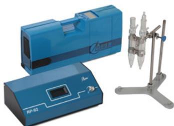
El accesorio **RP-92** y el instrumento **RA-915W** están diseñados específicamente para un análisis rápido de sub-ppt de muestras líquidas utilizando la técnica clásica de vapor frío.
