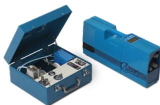
El accesorio **RP-91NG** permite el análisis directo de gases de hidrocarburos con composiciones complejas. Esta técnica simplifica en gran medida el proceso de muestreo y permite el análisis tanto de corrientes de gas como de contenedores de gas, como bolsas de Tedlar® y cilindros.
